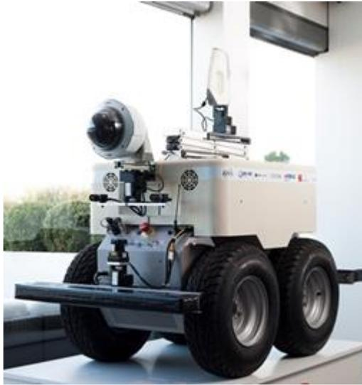
Le projet "AIR-COBOT" (Aircraft enhanced Inspection by smaRt Collaborative rOBOT = Inspection améliorée des aéronefs via un robot collaboratif intelligent) a pour but de **concevoir et mettre au point un robot mobile collaboratif pour inspecter des avions**.
